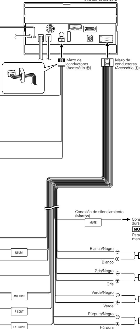
Conecte al terminal puesto a masa ya sea al sonar el teléfono o durante la conversación.
