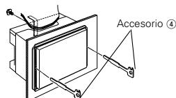
Preste atención para no lastimarse con las uñas de la herramienta de extracción.
